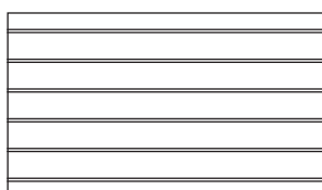
ΠΛΑΚΑ ΜΕ ΙΣΙΕΣ ΕΓΚΟΠΕΣ ΠΑΧΟΥΣ 15mm με βήμα 10 cm
