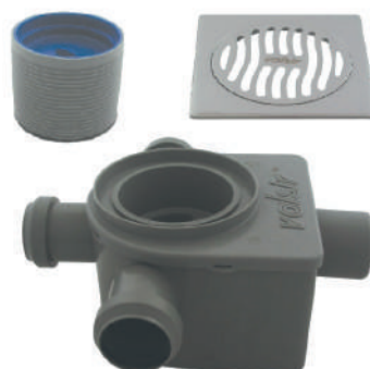
ΣΙΦΩΝΙ ΜΕ ΜΙΑ ΕΞΟΔΟ Ø50 και 3 εισόδους Ø40 με ποτήρι και λάστιχο διπλού χείλους
